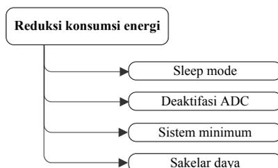
Gambar 1. Metode untuk mereduksi konsumsi energi
